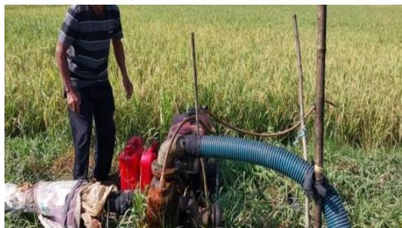
Gambar 7. Pemasangan selang spiral untuk mengairi persawahan/pengaturan air
